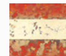
Micrographie d'un joint brasé avec une brasure à haute teneur d'Argent.
